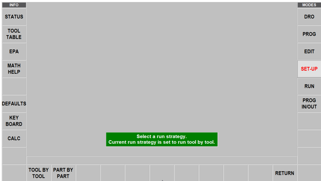
Figura 12.5 ProtoTRAK RMX que muestra las teclas virtuales de estrategia de ejecución con la estrategia Tool by Tool (Herramienta por Herramienta) establecida.
