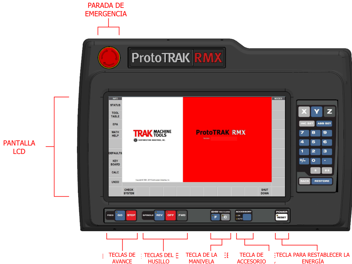
Figura 3.3.1 Parte frontal del panel colgante del controlador de la ProtoTRAK RMX.
